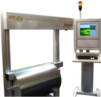
**Bulge3D** arbeitet nach dem Prinzip der optischen Triangulation mittels statischer Streifenprojektion.
