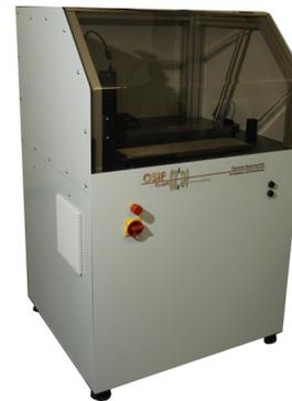
Der **ScreenInspector** dient der Inspektion von gerahmtem Siebdruckgewebe und den auf den Geweben aufgetragenen Siebdruckmasken. Erkannt werden z.B. zu kleine und zu große Maschen sowie Fremdkörper oder Löcher im Gewebe. Die Maske wird mit Hilfe der geladenen CAD-Daten überprüft.
